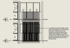
TYPICAL RETRACTABLE BALCONY SCREEN(CLOSED) - ELEVATION 1
